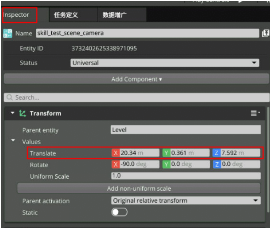
图 5-9 调整观测相机位置数值示例（坐标轴）
